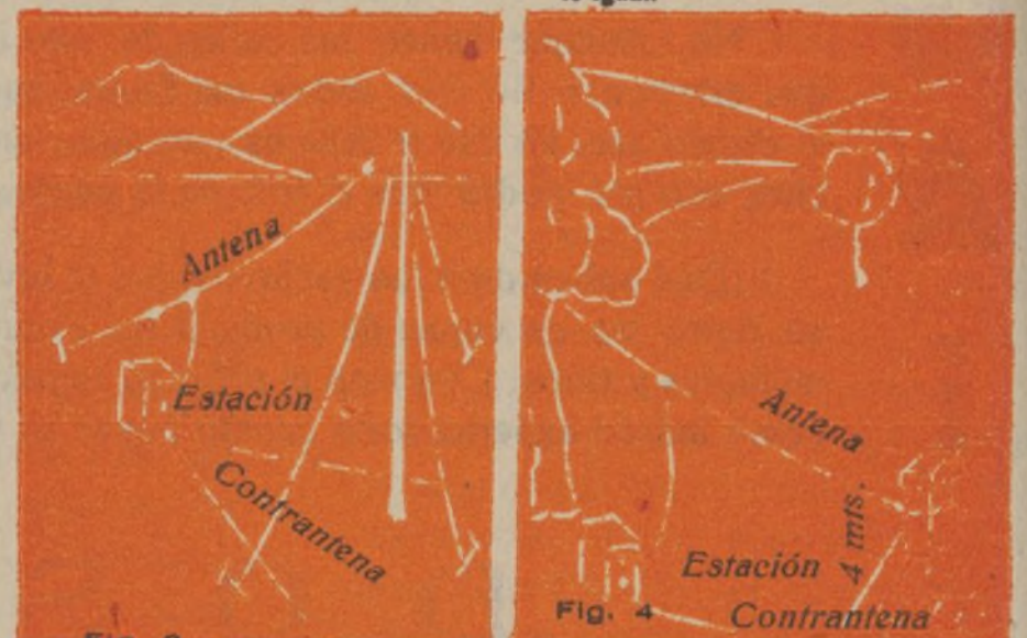
Fig. 3 Antena inclinada y contrantenas debajo de la misma y de longitud aproximadamente igual.
