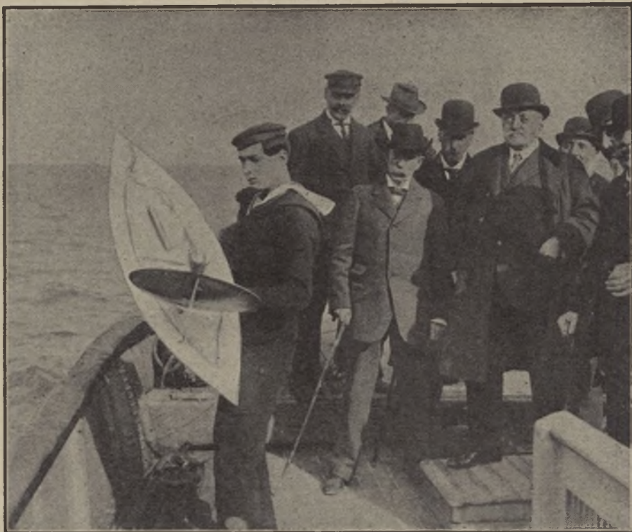
Barcelona.—Pruebas de un boyarín portamantas para salvamentos, inventado por el notable escritor y marino D. Pedro Novo y Colson. (Fot. Castellá.)
